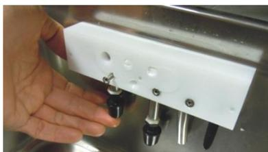
11. Maintenir le flotteur en position haute et visser la vis de maintien
