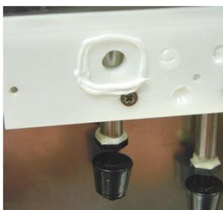
12. Mettre un cordon de silicone autour du trou et fixer le carter en inox (3 vis). Mettre un cordon de silicone autour du tube inox du flotteur afin de réaliser l'étanchéité entre le flotteur et le bloc en plastique blanc.
