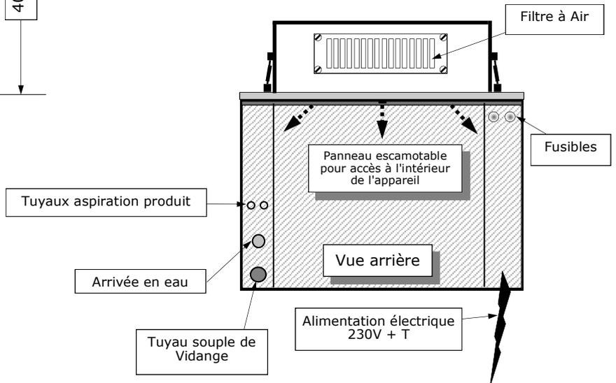
**L'ensemble des raccordements s'effectue sur la partie arrière de la carrosserie de l'appareil.**
