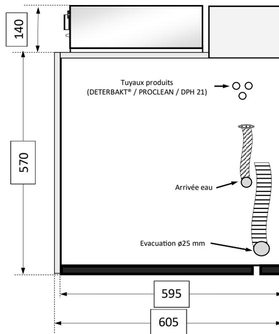
Le tuyau d'arrivée en eau et le tuyau de vidange sont raccordés en usine sur l'appareil
