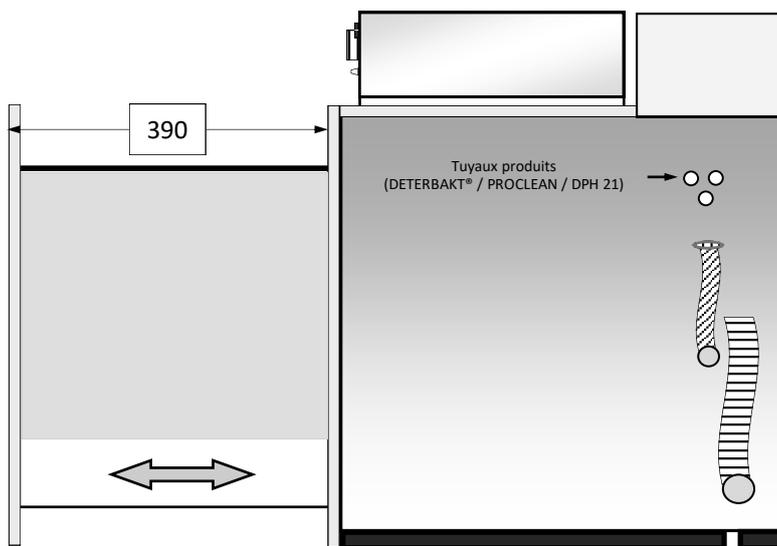
Les 3 bidons de produits détergents se positionnent dans le module situé à droite de l'appareil
